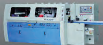
刨锯联合机 (护罩型四面刨带立轴对剖锯)
