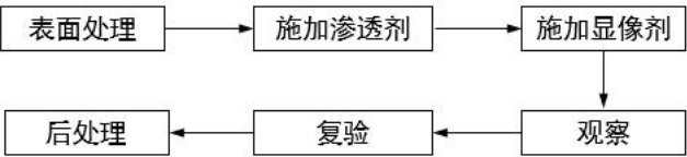
图 5.3.4 渗透检测流程
